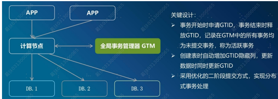
图 4.1-1 GoldenDB 分布式事务控制关键设计
