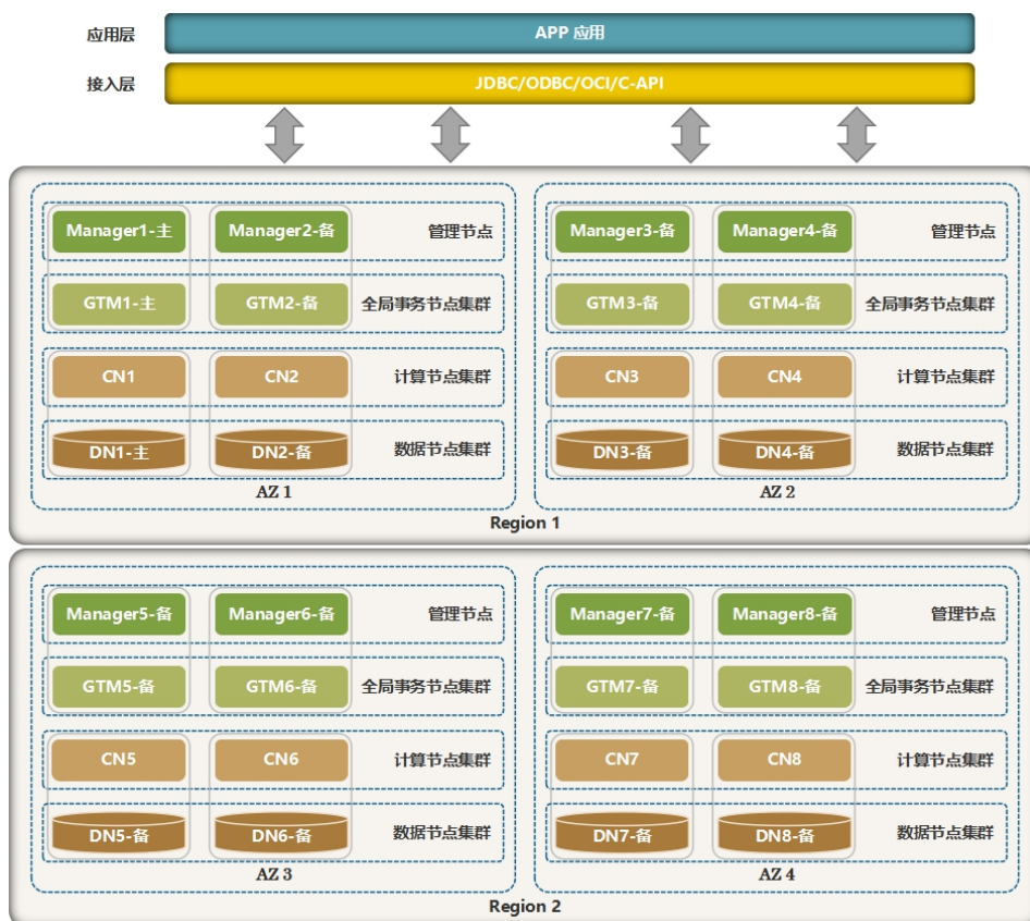
图 3.3-6 两地四中心高可用组网图
