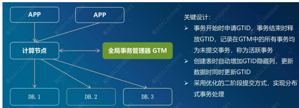
图 4.1-1 GoldenDB 分布式事务控制关键设计
