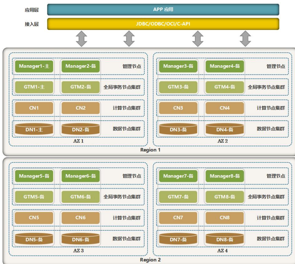
图 3.3-6 两地四中心高可用组网图
