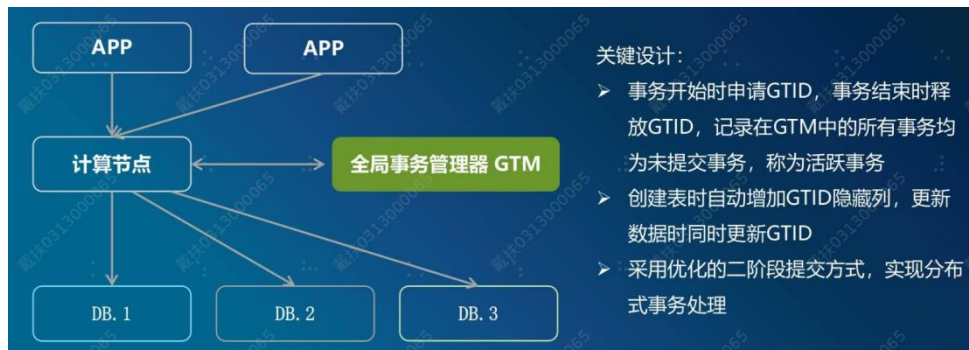
图 4.1-1 GoldenDB 分布式事务控制关键设计
