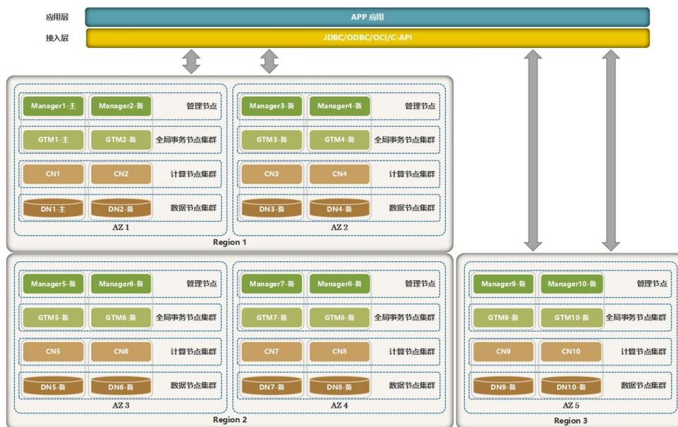
图 3.3-7 三地五中心高可用组网图
