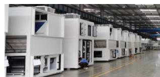
中国建设银行 间接蒸发冷却空调
