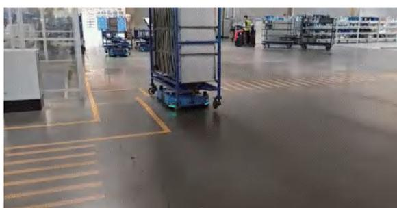
中兴通讯为吉利领克汽车提供了总装车间智慧物流配送、总装视觉防错等 5G 应用场景，应用了动态区域检测、反光柱辅助定位、置信度调整等一系列增强技术，实现了全国首个 5G 激光 SLAM 导航 AGV 在车厂复杂环境下（环境高动态、叉车牵引车无序、三种车型混产）大规模应用。
