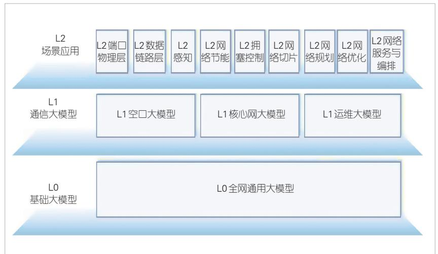
▲图5 网络大模型NetGPT的3层架构<sup>[34]</sup>
