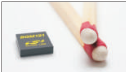
▲图16 Silicon Labs公司的蓝牙CMOS芯片内置封装天线实物照片
