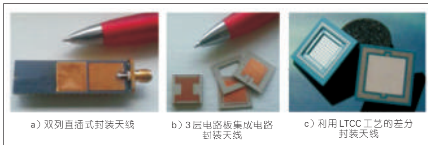
▲图2 封装天线技术的进化
