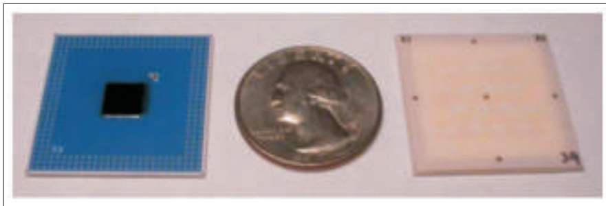
▲图7 IBM公司60 GHz LTCC封装天线SiGe芯片实物照片
