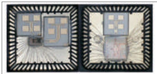
▲图 13 122 及 145 GHz 封装天线 SiGe 芯片实物照片
