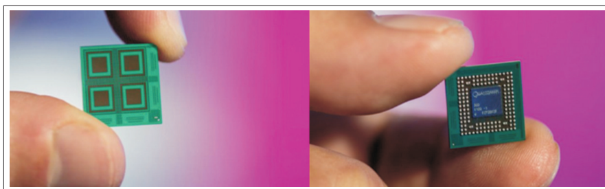
▲图18 Qualcomm公司用于5G NR首款智能手机参考设计中采用封装天线技术的28 GHz毫米波芯片实物照片
