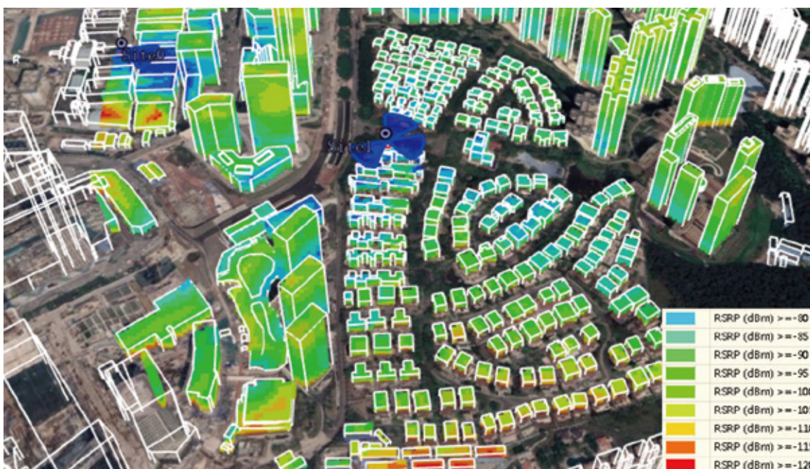
图2 三维地图上的站点部署和RSRP预测图
